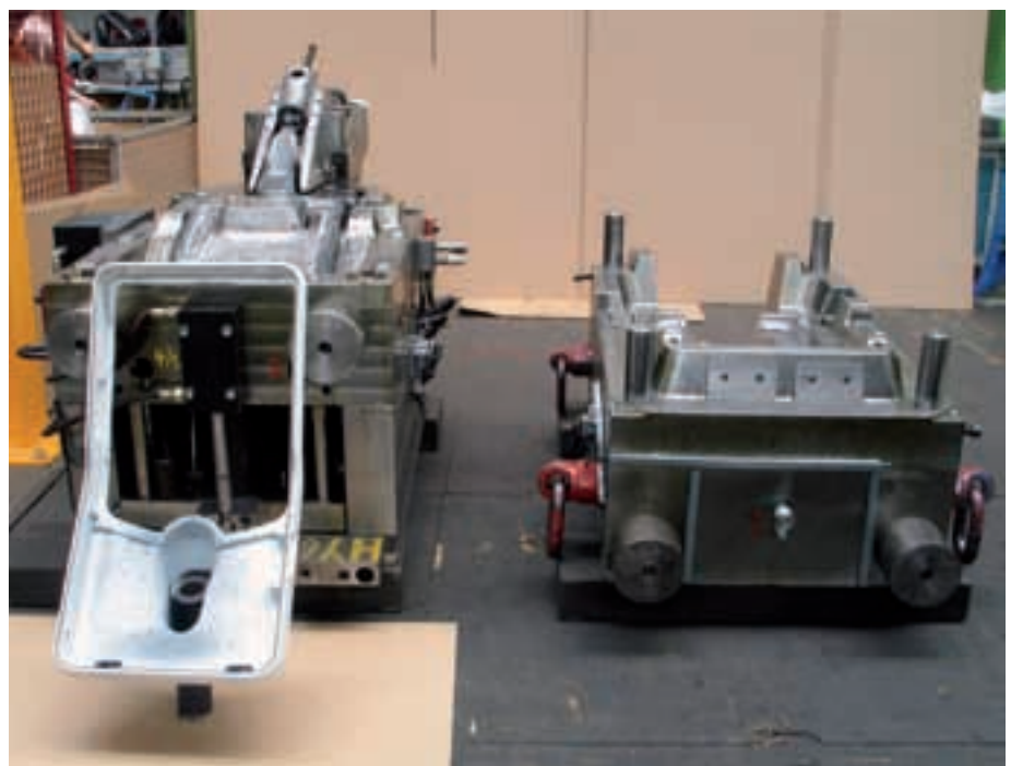
Illustration 1: cette coque de boîtier moulée par injection est prête au montage. La forme dépend des outils utilisés et répond aux exigences esthétiques actuelles.
