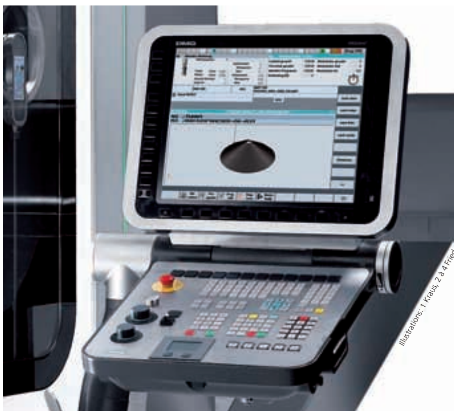
Illustration 4 : cette commande de machines-outils se doit d'être esthétique. Le procédé TSG offre donc des perspectives très intéressantes pour la fabrication de ses coques de boîtier.
