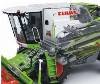
Links: Spezialist fürs Große – das Mähdrescherdach wird aus zwei Spritzgussteilen hergestellt, die 20 und 30 Kilogramm wiegen. Rechts: Aus der Luft sieht man Hunderte Quadratmeter Solaranlagen.
