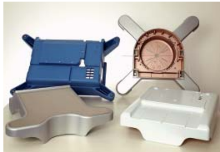
Geräteträger, die im Thermoplast-Schaumspritzgieß-Verfahren hergestellt werden, sind in ihrer Form und Farbe so variabel, wie es der Konstrukteur vorsieht
