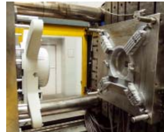
Die komplexen Formen für großvolumige Teile stellt ein Spezialist nach den Vorgaben von Fried her. Die eigenen Mitarbeiter lagern und pflegen diese und produzieren damit die Geräteträger auf leistungsfähigen Spritzgussmaschinen. Bilder: Fried
