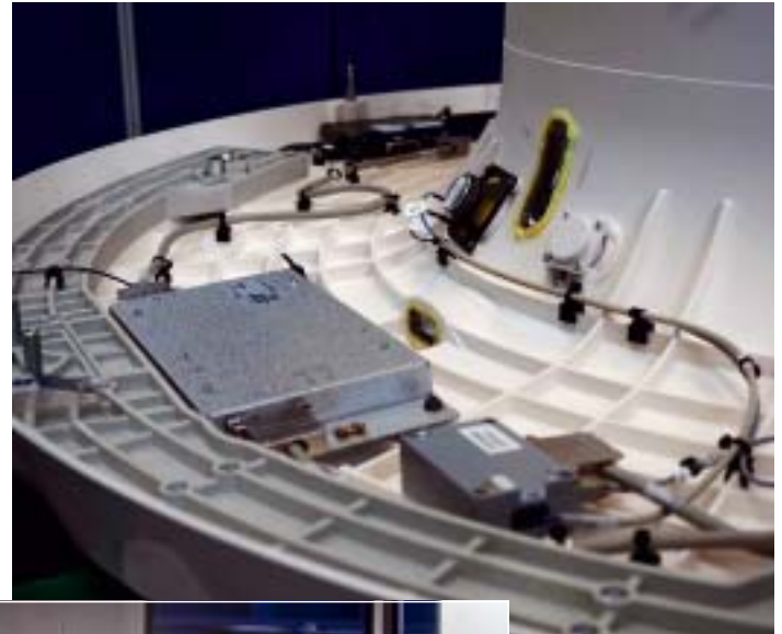
Die Komplettierung und Funktionsprüfung der lackierten Spritzgussteile mit elektronischen Baugruppen und Verkabelung erfolgt im Fertigungsablauf (oben)
