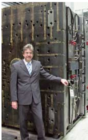
Geschäftsführer Ralf Krüger vor der Form des Kabinendachs. Eine solche Form wiegt über 50 Tonnen.
