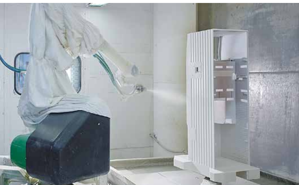
Bild 1 | Lackierung mittels Roboterarm: Geräte zur Hämodialyse werden innen mit Leitlacken beschichtet, damit eventuell auftretende elektromagnetische Felder nicht zu einer Fehlfunktion führen.
